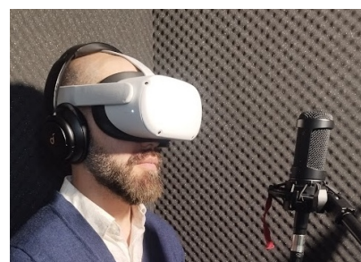
Figura 19. Posicionamiento del usuario con las gafas de realidad virtual y el micrófono para grabación. En la figura, el usuario está dentro de la cabina sonoamortiguada.
