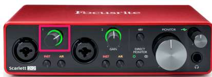
Figura 20. Interfaz de Audio Focusrite Scarlett 2i2. El recuadro muestra el control de intensidad (ganancia) del micrófono al 70%.
