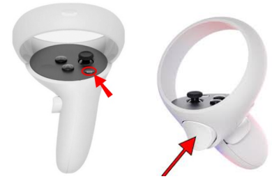
Figura 28. Arriba muestra el botón de menú en el joystick derecho. abajo, se muestra el botón de gatillo. Ambos esquemas son del joystick derecha del sistema de realidad virtual Oculus Quest 2.
