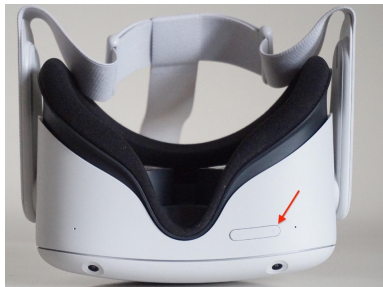
Figura 22. Vista inferior de las gafas de realidad virtual Oculus Quest 2. La flecha roja indica los botones de selección de intensidad sonora del dispositivo.
